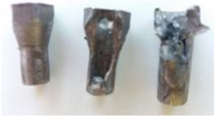
Рис. 5. Результати експериментальних досліджень по пробиттю перешкоди у вигляді пустотілих циліндрів
