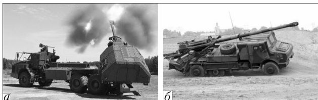
Рис. 7. Самохідні артилерійські гаубиці: а — «Арчер»; б — «Цезар»
