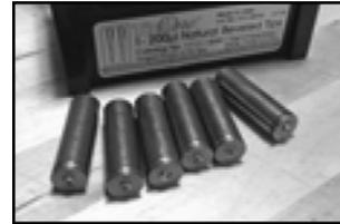
сталі. Гильза виконує роль ствола. В якості пулі використовується металева кулька, яку заглиблено в гильзу на 25 мм. Який тип порошу вживається, на жаль, розробниками не уточнюється.
