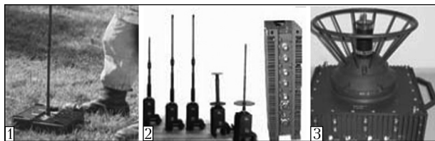
Рис. 2. Засоби групового захисту броньованих машин [9,10,16]: 1 – ELTA-20; 2 – РР-377ВМ1; 3 – МПП-1
