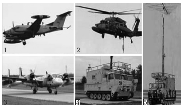
Рис. 4. Засоби розвідки та радіоелектронної боротьби, які поєдnano в автоматизовану систему управління ASAS-BETA [13]: 1 – RC-12K; 2 – EH-60; 3 – OV-10D; 4, 5 – AN/MLQ-34
