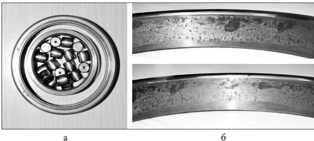
Рис. 1. Роликовий підшипник (а) опори турбіни авіаційного двигуна РД-33 й корозійні пошкодження (б) на зовнішній обоймі
