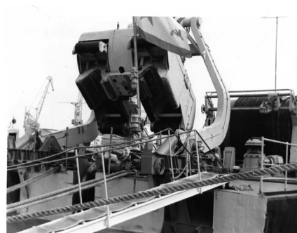
Рис. 15. Подъемно-опускное устройство буксируемых ГАС противолодочных кораблей ВМФ России
