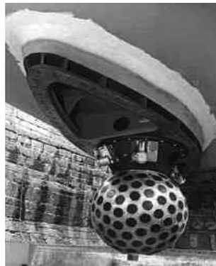
Рис. 2. Сферическая антенна ГАС «Spherion» ВМС Франции
