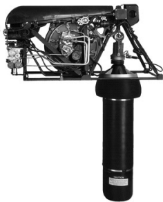
Рис. 12. Подъемно-опускное и антенное устройства ГАС AN/AQS-18 (США)
