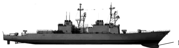
Рис. 6. Эсминец США «Spruens» с гидроакустической антенной (1) ГАС SQS-53 в носовой оконечности
