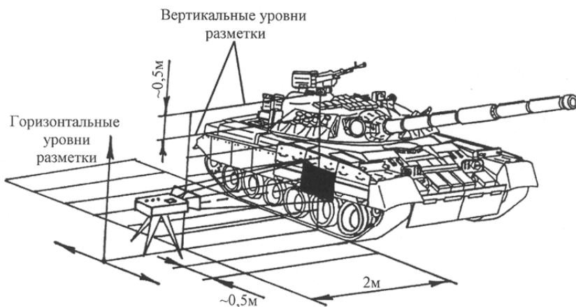
Рис. 3. Схема измерения коэффициентов отражения методом декомпозиции
