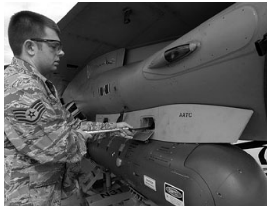
Рис. 3. Встановлення підвісного контейнера апаратури VTID компанії «Raytheon» на літаку F/A-18
