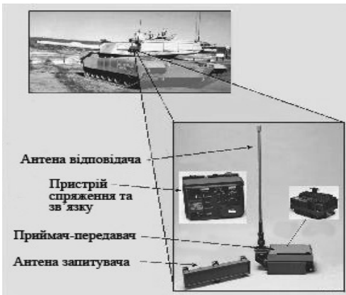
Рис. 2. Встановлення запитувача-відповідача AN/VSX-4 на танку M-1 «Abrams»
