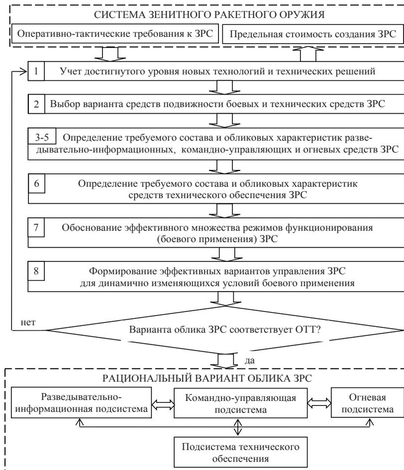
Рис. 2. Алгоритм функционального синтеза облика ЗРС нового поколения
