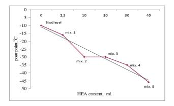
Fig. 4. The pour point of the investigated mixtures
