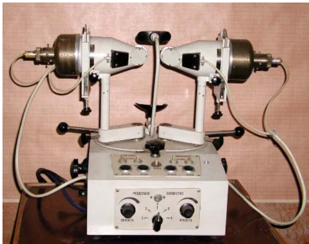
Рис. 1. Общий вид устройства для определения девиации глаз у больных с непрозрачными оптическими средами.
