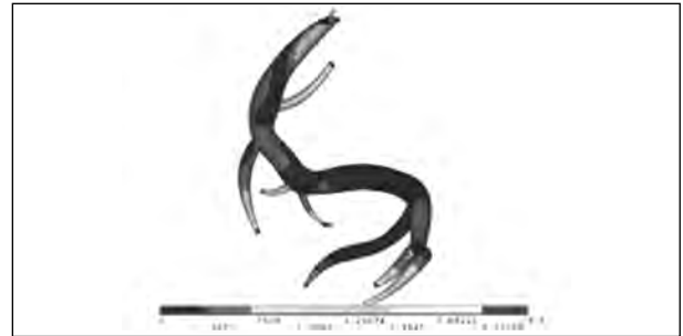
Рис. 12. Распределение значений касательных напряжений на стенках ПКА
