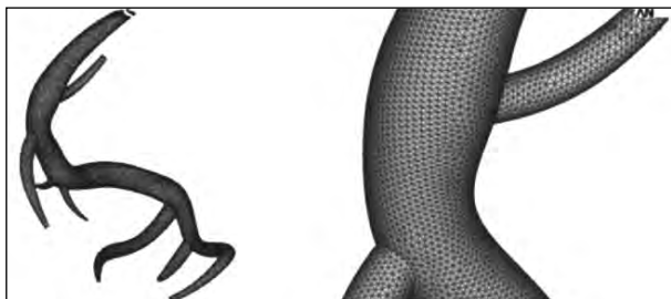
Рис. 5. Наложение расчетной сетки на модель коронарных артерий
