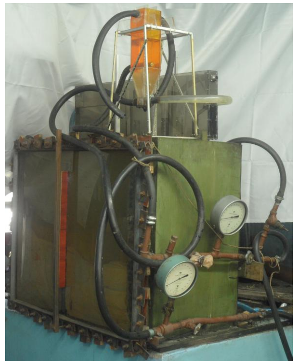
Рис. 4. Лабораторная установка для исследования гравитационного разделения зернистых материалов
