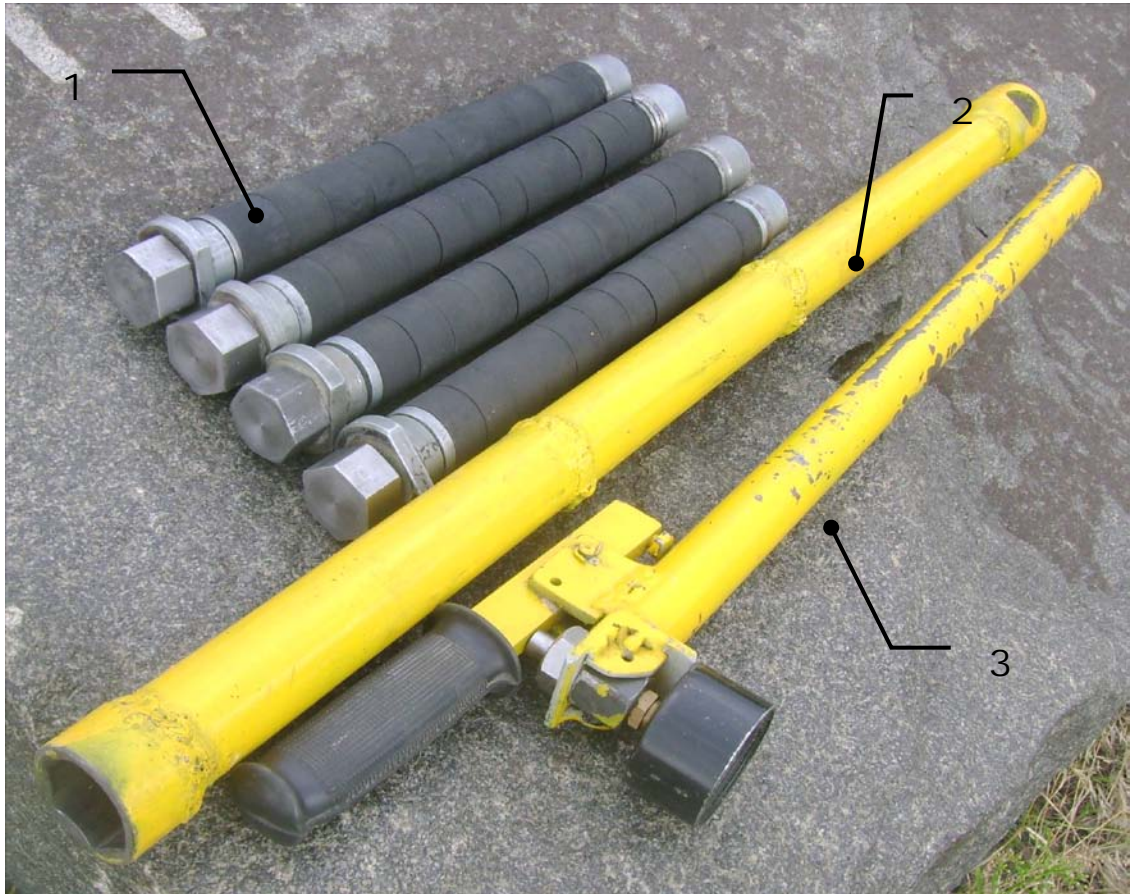
Рис. 2. Партия експериментальних гідроагрегатів (поз. 1) та гідравлічний динамометричний гайковий ключ (поз. 2 та поз. 3)
