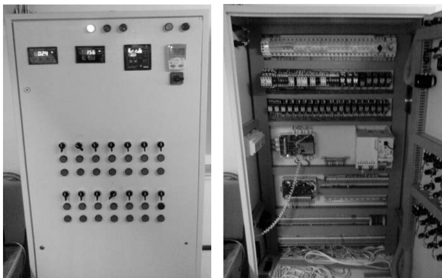
Рис. 2. Стенд АСКУ параметрами воздушной среды лабораторного комплекса
