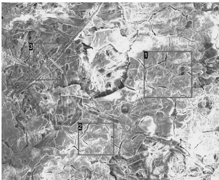
Рис. 2. Схема аналізу нерозчинного осаду ЗА (дослідні електроди) на фільтрі за допомогою енергодисперсійного спектрометра INCA Energy-350
