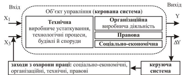
Рисунок 2 – Структурна схема системи управління охороною праці
