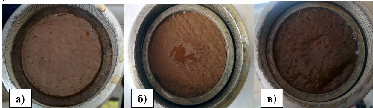
Рисунок 3 - Осад після фільтрування сиропу: а) - після випарки(контроль); б) - з додаванням флокулянту 0,05 % до кількості СР; в) - з додаванням флокулянту 0,1 % до кількості СР
