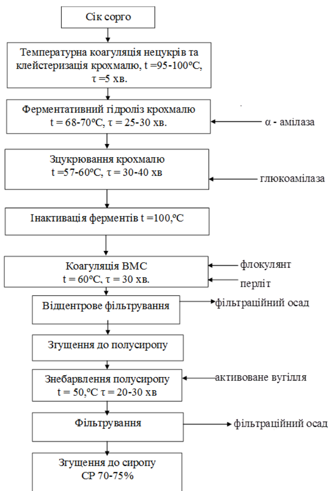
Рис. 2. Принципова технологічна схема отримання цукровмісного продукту із цукрового сорго
