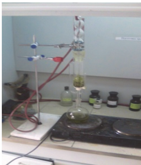
Рис.1. Екстрактор Сокслета (який складається з перегінного куба; сифонної трубки; безпосередньо екстрактора; холодильника-конденсатора).
