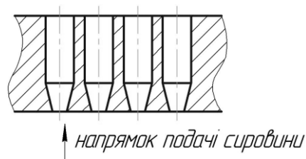
Рис. 6. Конфігурація отворів решітки вовчка зі зменшеним гідравлічним опором
