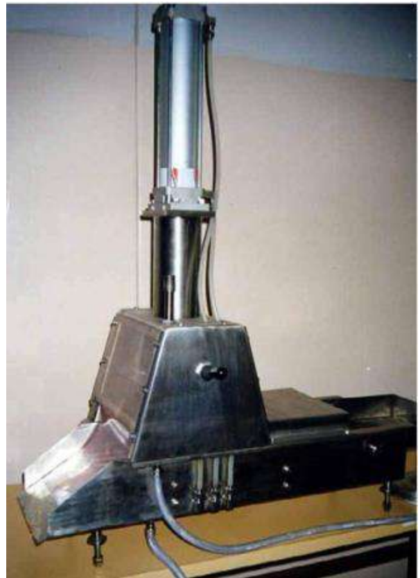
Рис. 6 Пневматичний ін'єктор-автомат Я5-ФШ1Л (розробка фахівців ППР НААН)
