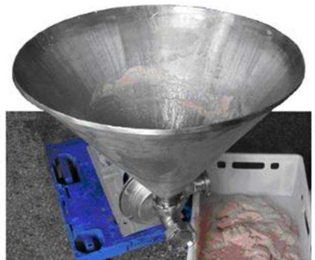
Рис. 7. Багатозубчастий подрібнювач Я5-ФП2Ф під час дослідів з подрібнення колагенвмісної сировини
