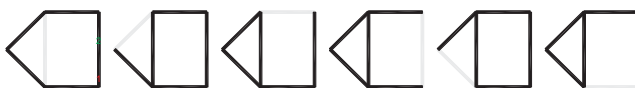
Рис. 2 Шість можливих неповторних працездатних станів структури з резервом, коли відмовила одна ділянка.
