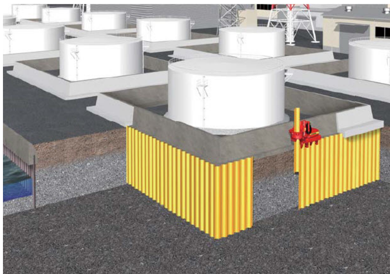
Рис. 9. Концепція № 4 – метод огороження ГЦЕ
