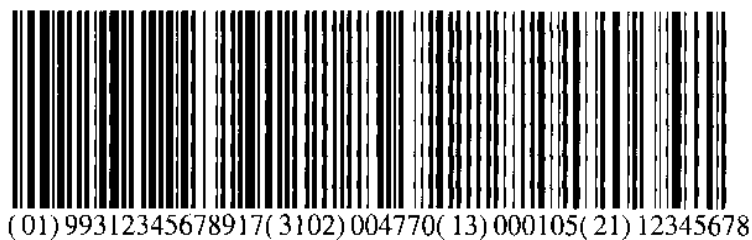
Рис. 2. Символи штрихового коду GS1-128 з включенням інформації коду ЄЕК ООН та іншої інформації щодо м'яса птиці, яку наносять на контейнер (приклад 2)
