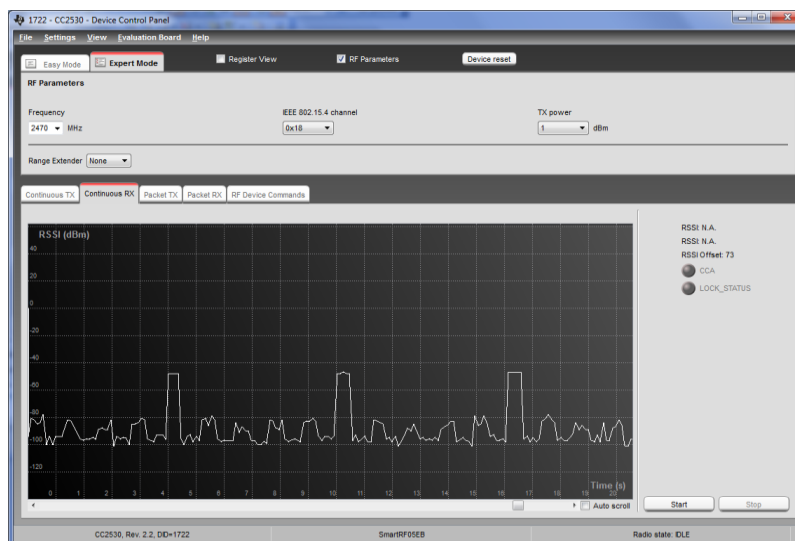
Рис. 13. Исследование влияния соседнего канала на измерения RSSI в интервале от 2460 МГц до 2480 МГц с шириной канала 5 МГц
