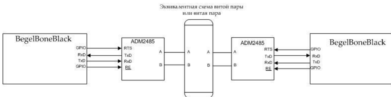
Рис. 9. Схема подключения тестового стенда для исследования передачи данных по сетям RS-485 и ProfiBus
