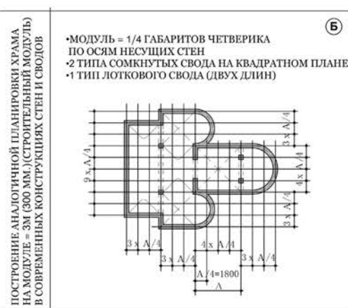
Рис. 5. Построение плана, аналогичного церкви Рождества Христова в Осташково, на основе модульной сетки с ячейкой, кратной 300 мм
