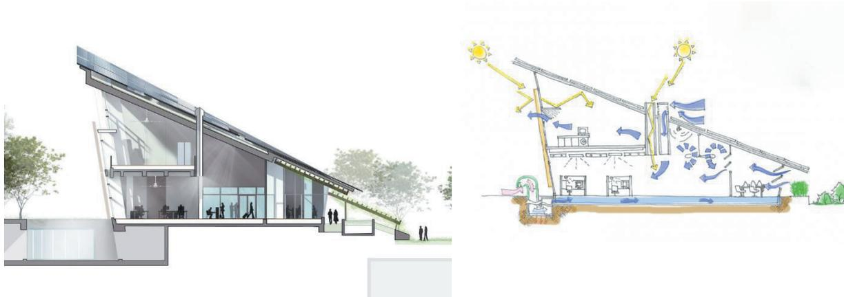
Рис.2. Разрез Zero Carbon Building
