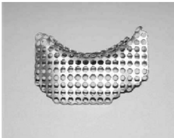
Рис. 4. Индивидуальный сетчатый имплантат из титана
