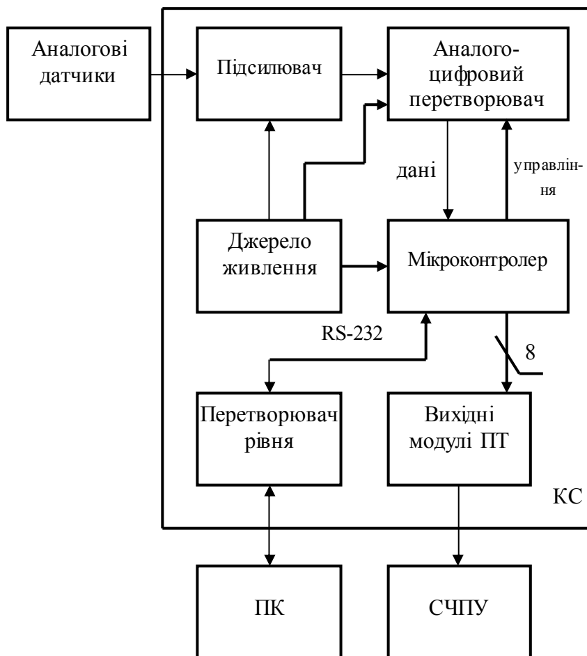
Рис. 2. Функціональна схема модуля сполучення
