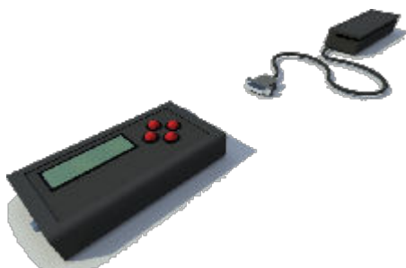
Рис. 1. Запропонований ОЕП динамічного випромінювання, контролю та корекції: зліва - блок керування, справа – блок вимірювання та опромінення.
