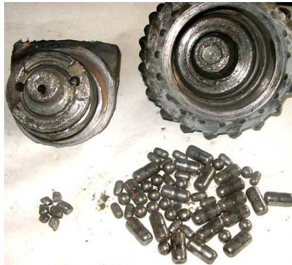
Рис. 3. Загальний вигляд зруйнованих і зношених цапфи лапи, порожнини шарошки та тіл кочення опори секції №3 відпрацьованого бурового долота 244,5ОК-ПВ
