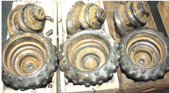
Рис. 1. Загальний вигляд робочих поверхонь цапф лап і порожнин шарошок I, II, III секцій опор відпрацьованого долота 244,5ОК-ПГВ (буріння породи в породах міцністю за шкалою Протодьяконова f=16 )
