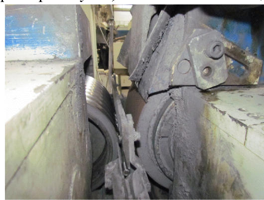
Рис. 2. Робоча зона безцентрово-шліфувального верстату SWaAKM25/1A.
