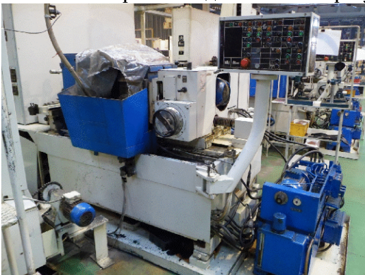
Рис. 1. Безцентрово-шліфувальний верстат SWaAKM25/1A для оброблення конічних роликів.
