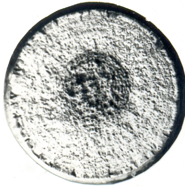
Рис.1. Вид зламу маркувального зразка.
