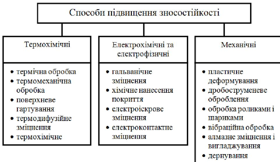
Рисунок 2. Способи підвищення зносостійкості.
