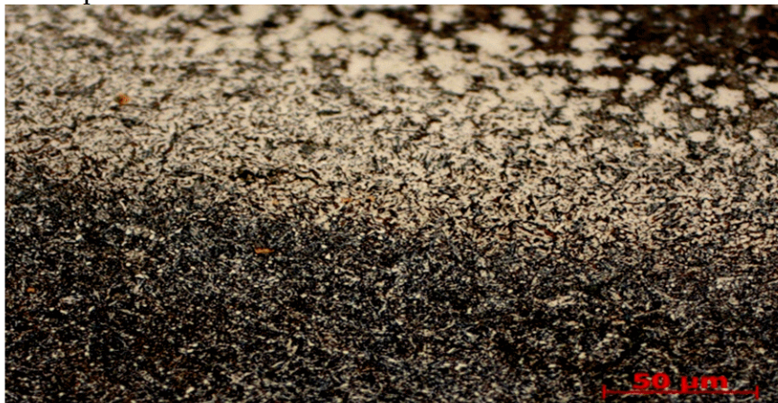
Рисунок 5 – Мікроструктура надповерхневого шару(сталь 40X10C2M) після лазерної термообробки, x800
