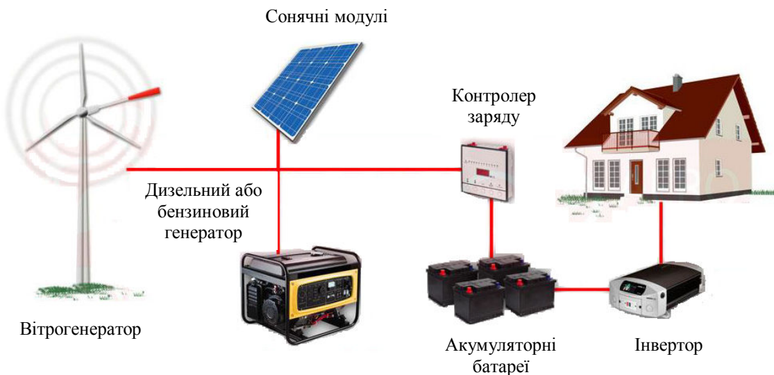
Рис. 1. Автономна гібридна система енергопостачання
