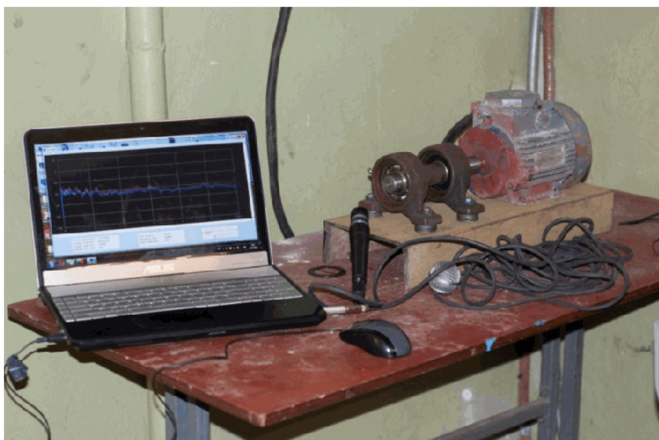
Рис. 2. Лабораторна установка для шумо-діагностичного контролю підшипників
