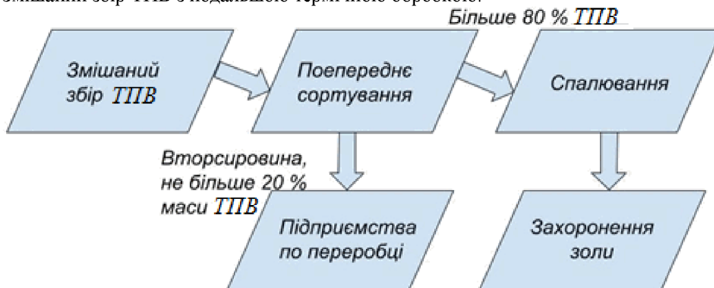
Рис. 3. Змішаний збір ТПВ з подальшою термічною обробкою
