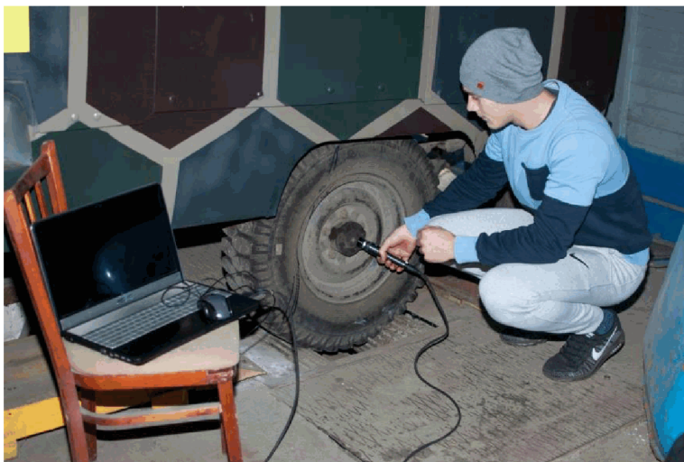
Рис. 2. Дослідження акустичних параметрів підшипників на стенді по дослідженню тягово-динамічних параметрів автомобілів .
