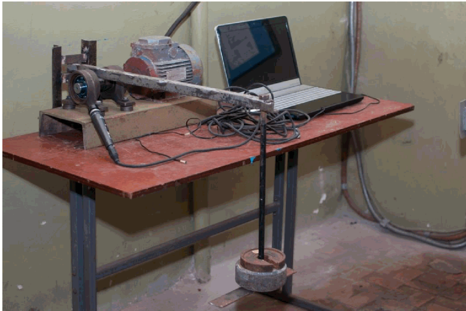
Рис. 1. Лабораторна установка шумо-діагностичного контролю підшипників кочення
