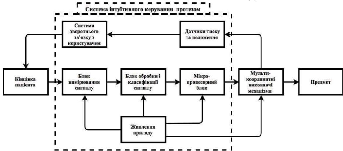
Рис. 1. Узагальнена структурна схема біонічного протезу кінцівки
