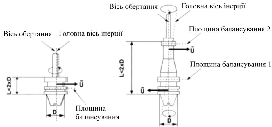
Рис.3. Дисбаланси оправок інструмента. Позначено: а) – статичний дисбаланс в одній площині; б) – динамічний дисбаланс в двох площинах [1].
