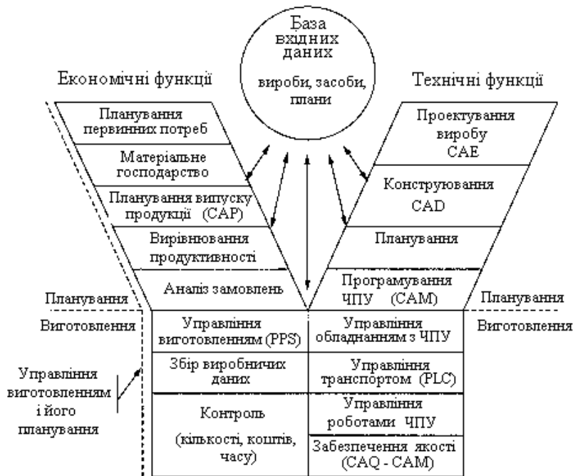
Рис.2. Модель ошадливого комп'ютерно-інтегрованого виробництва СІМ
