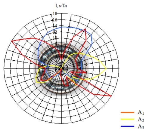
Рис. 4. Розподіл магнітної індукції  $I$  поверхонь деталей підшипника відносно радіусів зовнішнього ( $A_1$ ) і внутрішнього кілець ( $A_2$ ) та сепаратора з тілами кочення ( $A_3$ ) після 20 хвилин намагнічування джерелом постійного МП
