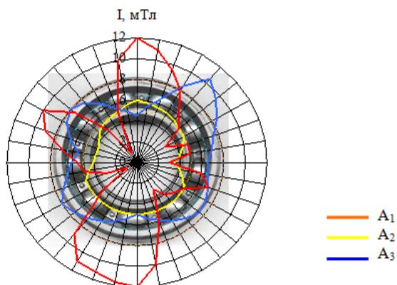
Рис. 5. Розподіл магнітної індукції  $I$  поверхонь деталей підшипника відносно радіусів зовнішнього ( $A_1$ ) і внутрішнього кілець ( $A_2$ ) і сепаратора з тілами кочення ( $A_3$ ) після очищення протягом 3 хвилин при частоті імпульсного МП 4800 Гц
