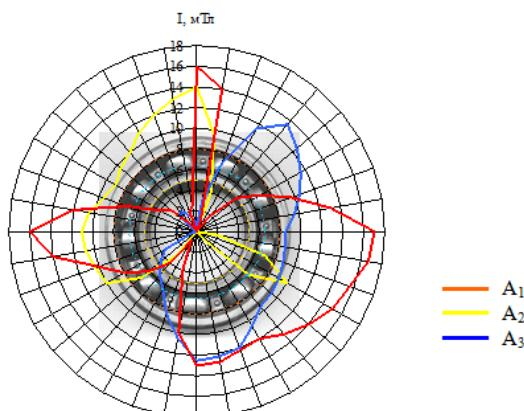
Рис. 3. Розподіл магнітної індукції  $I$  поверхонь деталей підшипника відносно радіусів зовнішнього ( $A_1$ ) і внутрішнього кілець ( $A_2$ ) та сепаратора з тілами кочення ( $A_3$ ) після 10 хвилин намагнічування джерелом постійного МП
