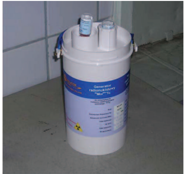
Рис. 2. Радіонуклідний генератор ^{99}\text{Mo}/^{99\text{m}}\text{Tc}
