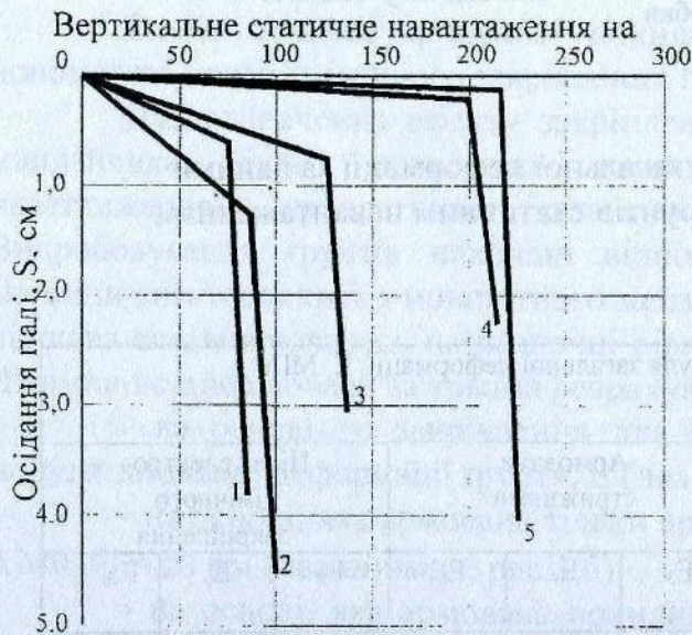
Залежність "осідання-навантаження" при кількості енергії на 1 м. п. палі: 1 – без закріплення; 2 – 9 кв/год; 3 – 18,6 кв/год;
