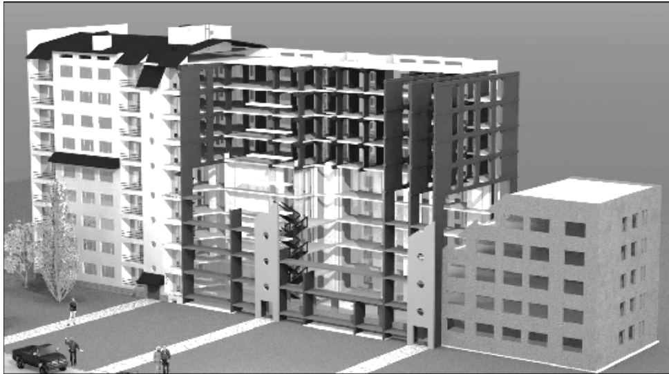
Рисунок 5 — Этапы реконструкции здания общежития по ул. Парковой, 75-б в г. Одессе
