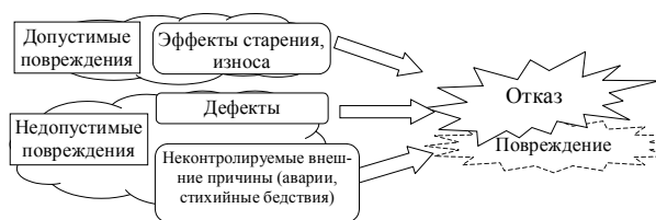
Рис. 1. Причинно-следственная связь возникновения отказа в физических системах
